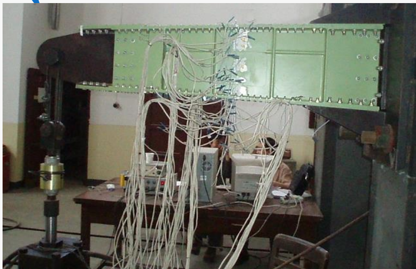
新支线飞机机翼整体梁损伤容限试验
