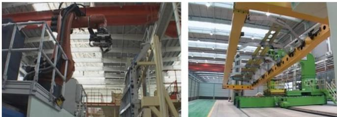
定位、制孔、连接3系列自动精准装配装备
