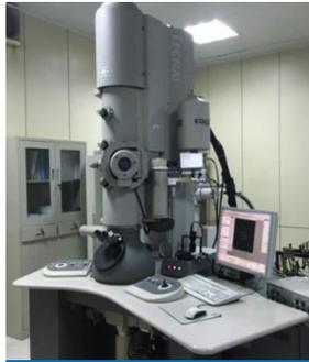
场发射透射电子显微镜
