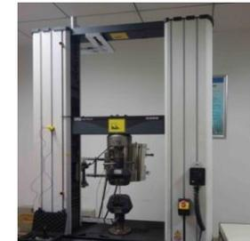
电子万能材料试验机
